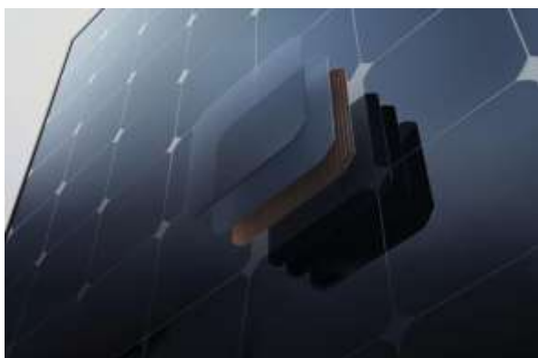
1-rasm. Maxeon quyosh elementining tuzilishi. 1-sof kremniy, 2- yorug'likni ushlab turadigan, ko'proq quvvatni tortadigan noyob sirt qoplamasi, 3- qattiq mis asosli taglik.
