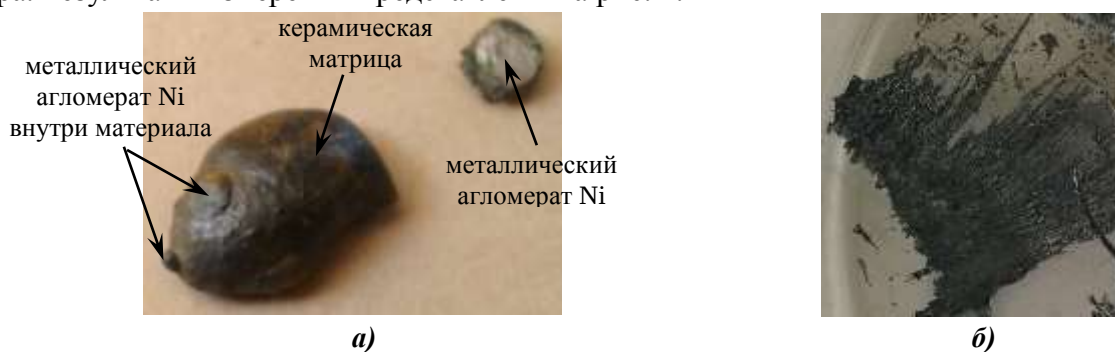
Рис. 1 Фотография синтезированного материала \text{TiO}_2 - \text{NiO} : а) полученного плавлением на воздухе и охлажденного на водоохлаждаемой подложке со скоростью \sim 10^2 ^{\circ}\text{C}/\text{c} ; б) полученного плавлением на воздухе с перегревом расплава и охлаждением закалкой со скоростью \sim 10^5 - 10^6 ^{\circ}\text{C}/\text{c}
