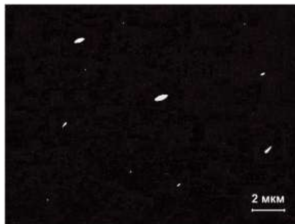
Рис. 1. Снимок примесных микровключений в образцах n\text{-Si}\langle\text{Ni}\rangle со скоростью охлаждения v_{\text{охл}}=400 К/сек.
